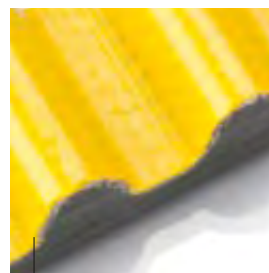
Speciální tkanina napuštěná polyuretanem Polyurethane-impregnated special fabric
