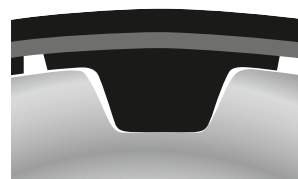
Mezera „SE“, zmenšená vůle Reduced backlash, “SE” tooth gap
